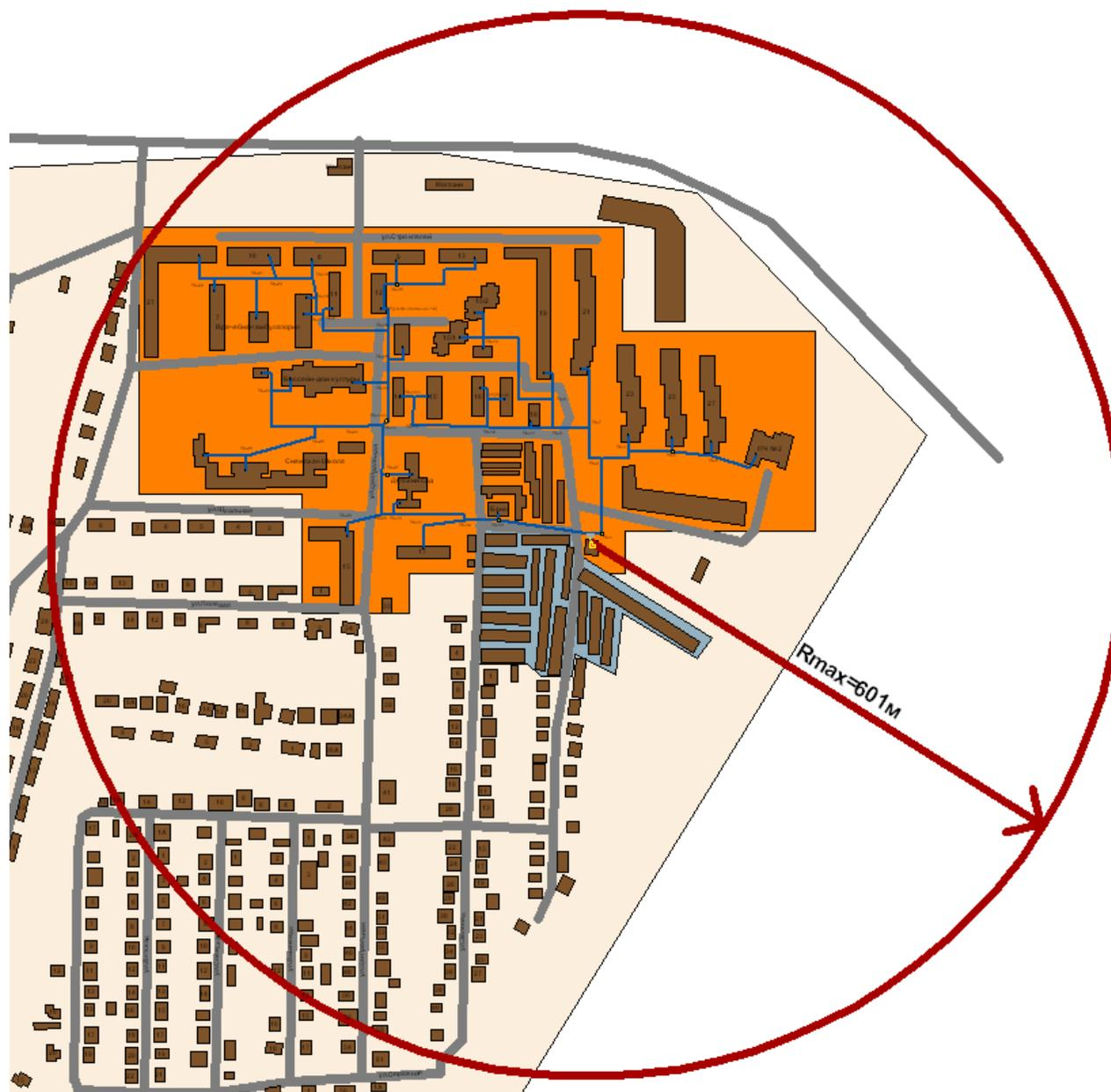
**Рис. 5** Радиус эффективного действия источника тепловой энергии котельной п. Путевка.
