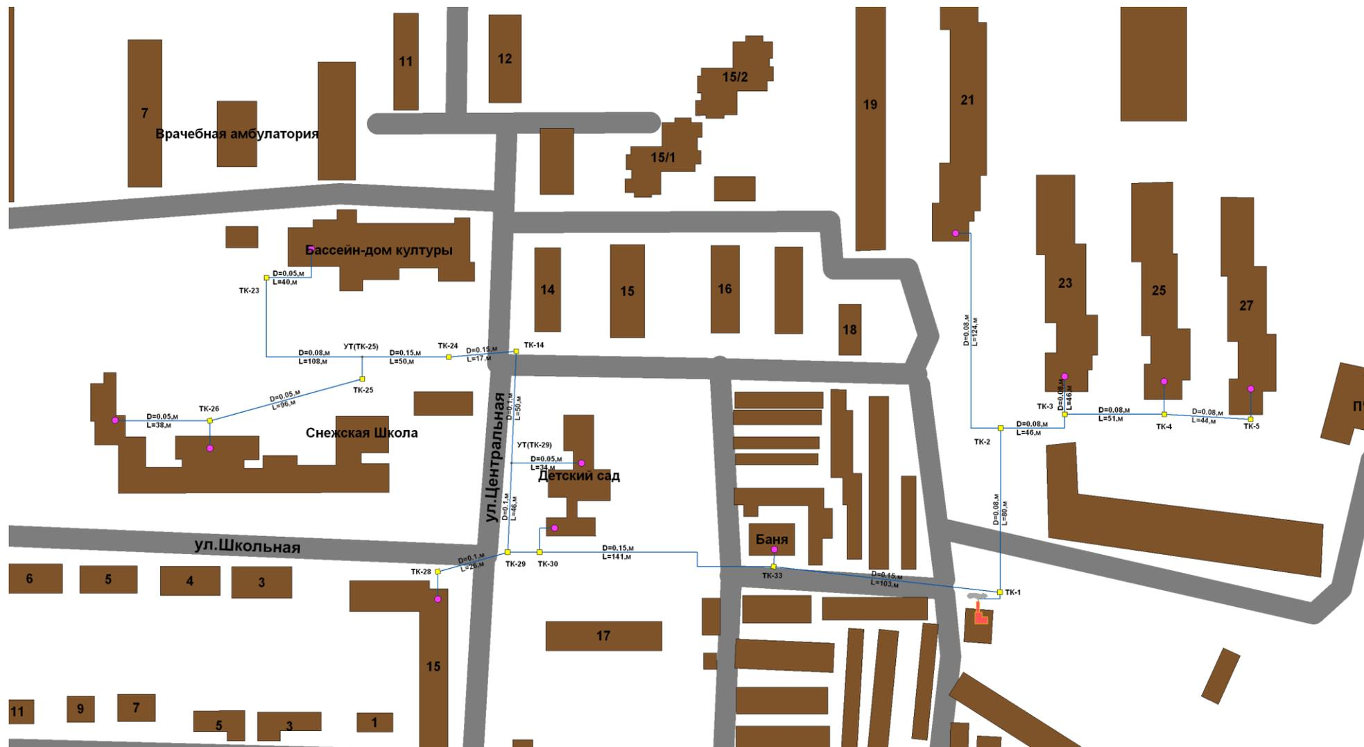
Рис.3 Схема тепловой сети системы горячего водоснабжения от котельной п. Путевка.
