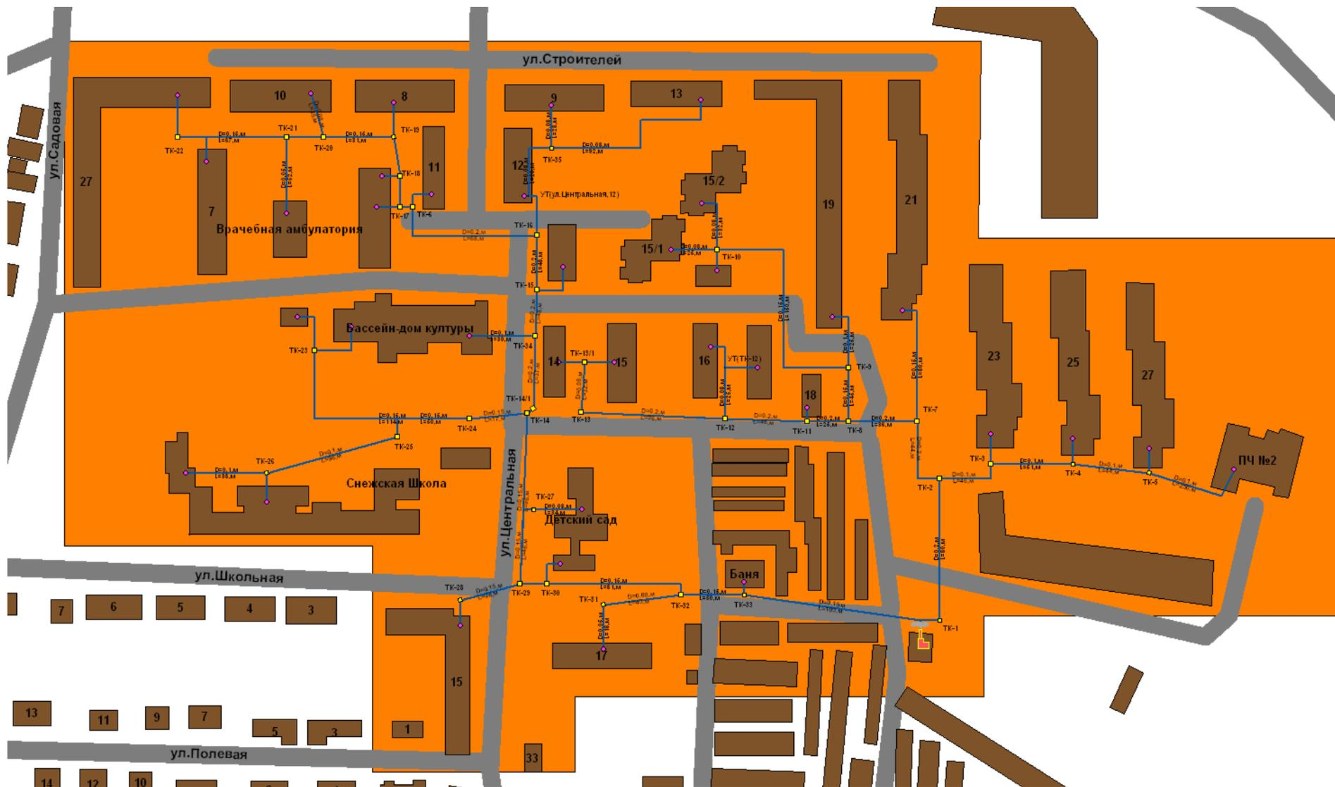
Рис. 9 Отапливаемая зона котельной п. Путевка.
