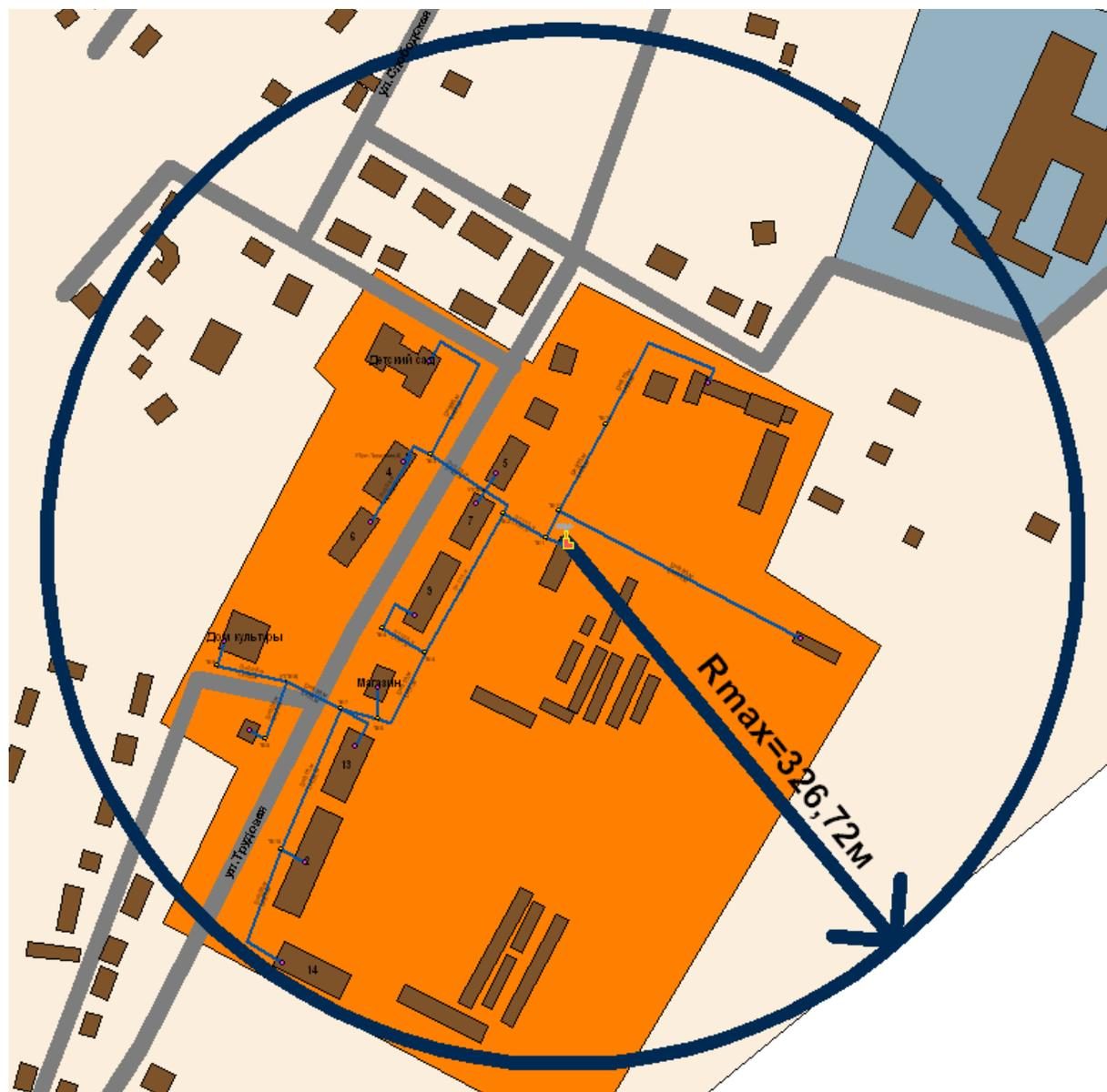
**Рис. 6** Радиус эффективного действия источника тепловой энергии котельной п. Толмачево.
