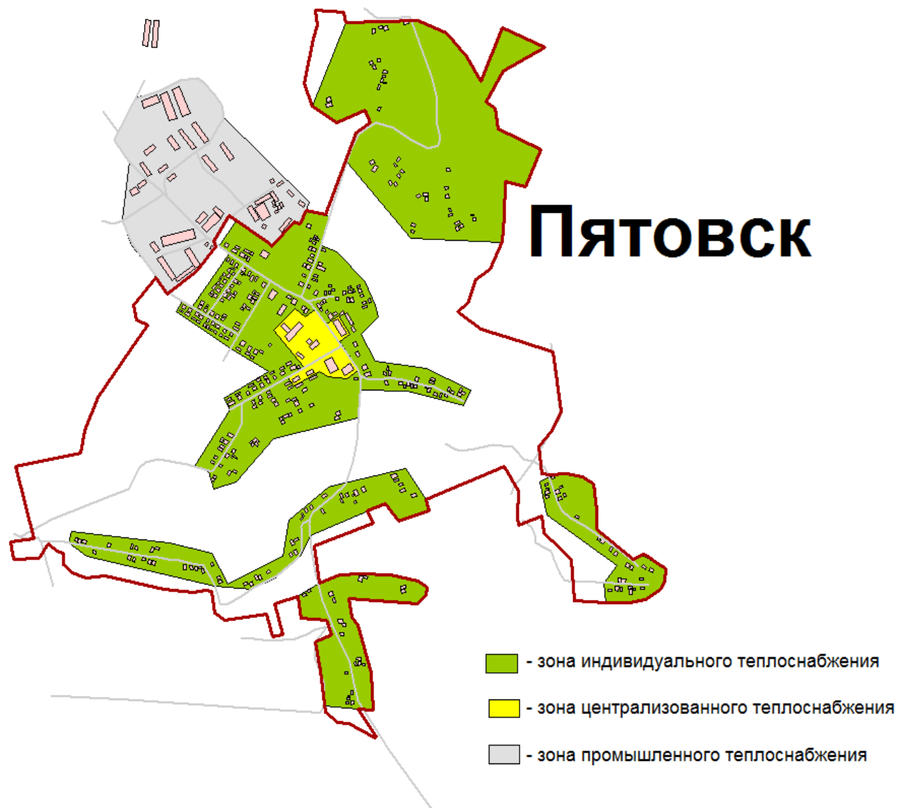
Рис. 6. Отапливаемая зона котельной № 15 с. Пятовск.
